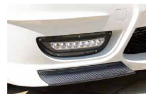
バンパー形状とよくフィットしたLEDデイトタイムライト風のポジションランプを搭載。
