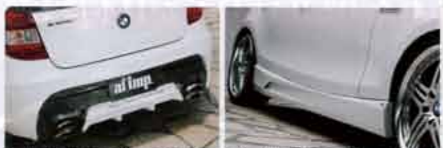
↑ ほどに圧倒的な存在感を放つアセクション。バンパーにインストールされたリアカーボンディフューザーが別体構造になっている点も驚きだ
