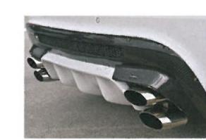
竹内さんのEVO93.1にはエナジーMS可 変バルブマフラーが装着されている。リ モコンにてバルブの開閉が出来る。高回 転での快音は病みつきになる。
